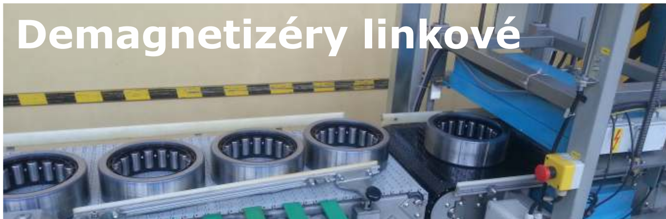
Ukázka použití deskového demagnetizéru umístěného ve výrobní lince na ložiska.
