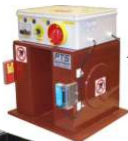
DZC-SP je určen k snížení zbytkového magnetizmu menších ložisek
